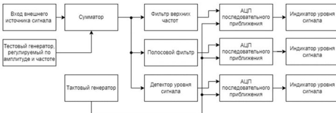
Рисунок 1. Структурная схема анализатора спектра
